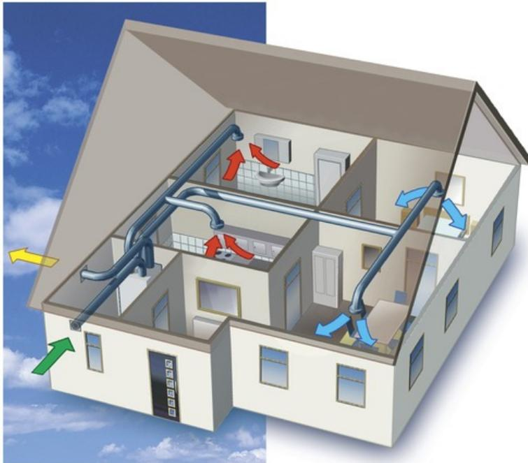
Durch Deckenventile (**rot**) wird Abluft von Bad, Küche, WC über den Wärmetauscher ins freie (**gelb**) geführt.
